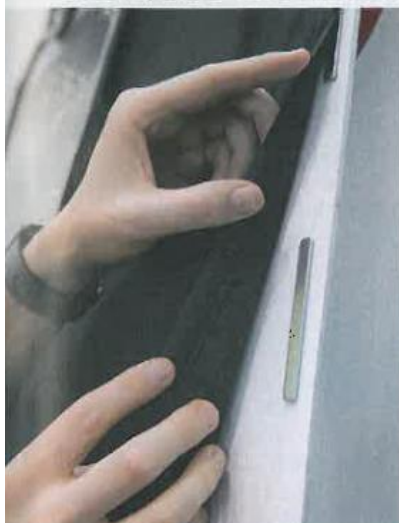
Mit Magneten haftet die Abdeckung am Frontscheibenrahmen.
