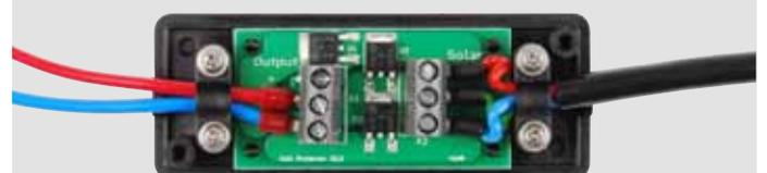
Mit dieser Anschlussart werden die Zellen durch zwei Bypass-Dioden vor dem Hotspot Effekt geschützt. Eine Sperrdiode schützt zusätzlich vor Rückstrom ins Modul. Werden mehrere Module parallel betrieben, kann so bei Beschädigung von einem Modul oder Kabel ein Einfluss auf weitere Module verhindert werden.
